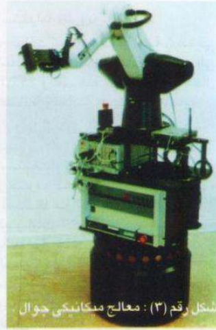
شكل رقم (٣): معالج ميكانيكي جوال من حرية الحركة Mobility ويستخدم بكثرة في المجالات البحثية.
